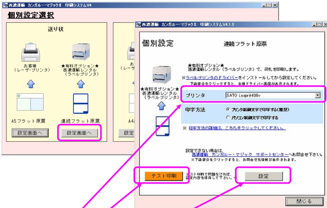
4. お使いのラベルプリンタを選択し、連続フラット原票をセットし、電源ランプと、オンラインランプが点灯している事を確認してから、**テスト印刷** をクリック
