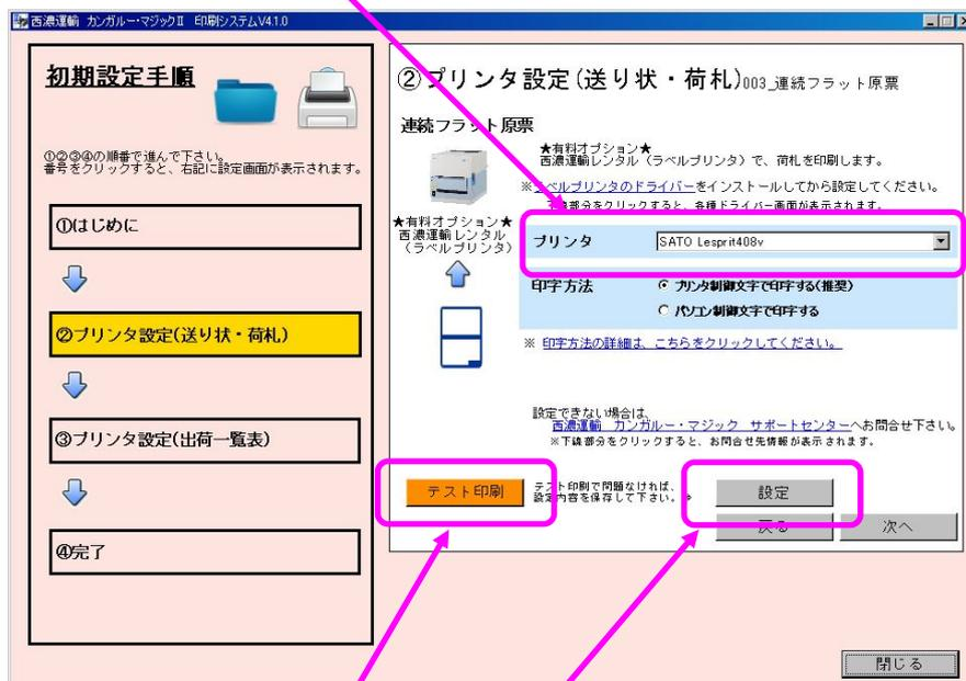
4. お使いのラベルプリンタに、連続フラット原票をセットし、電源ランプと、オンラインランプが点灯している事を確認してから、**テスト印刷** をクリック
